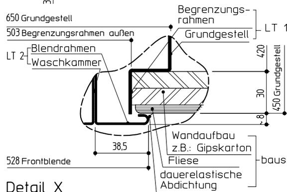
Montage des Grundgestell auf den aus. Estrich. WC Keramikhöhe: 400mm ±10mm (gültig für alle Wand WC's nach DIN EN 38 mit einem Schraubenabstand von 180 mm). Bei Montage auf dem Rohfußboden oder einer anderen Keramikhöhe kann ein zusätzlicher Ausgleichsrahmen mit geliefert werden. (siehe Detail Z).
