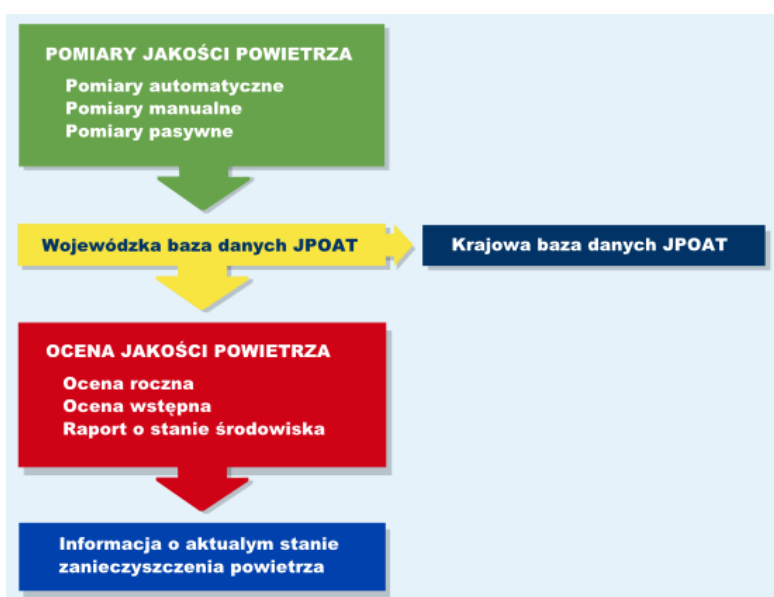
Rysunek 3.34 Schemat funkcjonowaniu monitoringu ochrony powietrza
