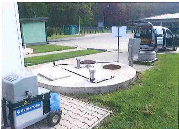
Fot. 5. Pobór próbek ścieków surowych z użyciem automatycznego próbkobiorcy Avalanche na Oczyszczalni w Chybiu
