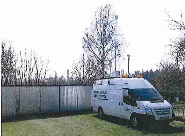
Fot. 4. Ambulans pomiarowy imisji zanieczyszczeń powietrza
