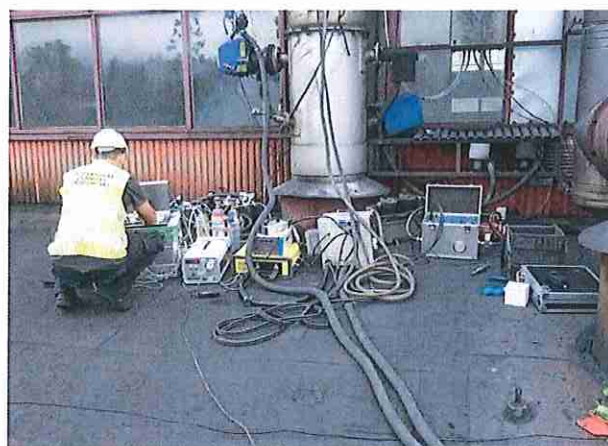
Fot. 4. Pomiar emisji zanieczyszczeń do powietrza ze Spalarni Odpadów Medycznych w Bielsku-Białej
