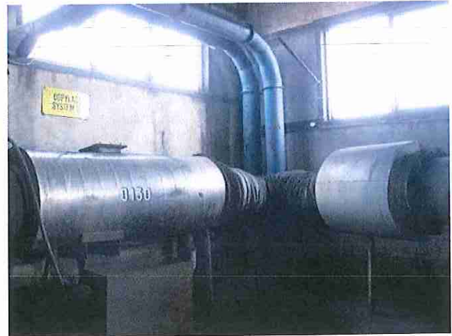
Fot. 2. Wytłumienie ulawiaczy pyłu na stacji przygotowania KW S.A., Oddział KWK „Jankowice”
