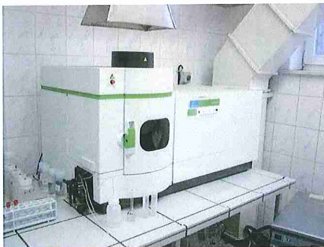
Fot. 3. Spektrofotometr ICP do oznaczania zawartości metali w próbkach
