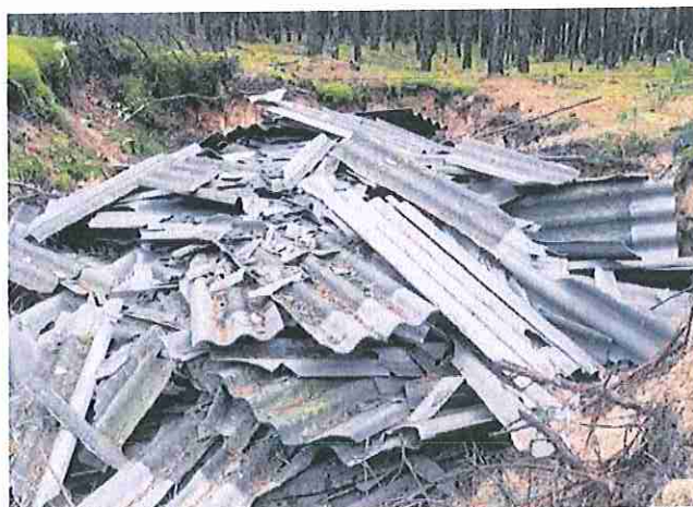
Fot. 3. Odpady azbestowe
