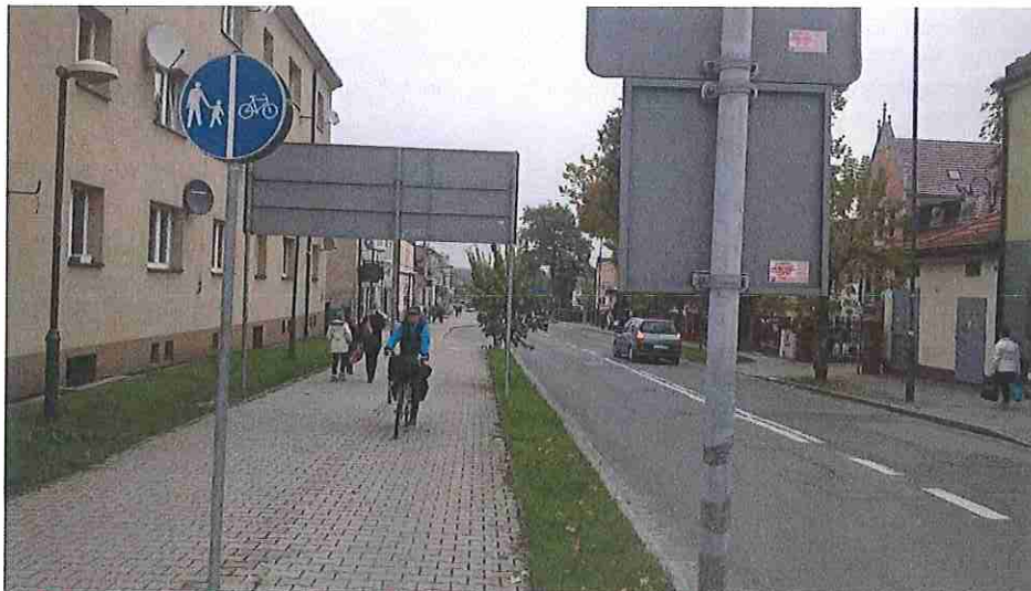
↑ Słupki znaków drogowych w skrajni drogi dla rowerów, ul. Dworcowa.
