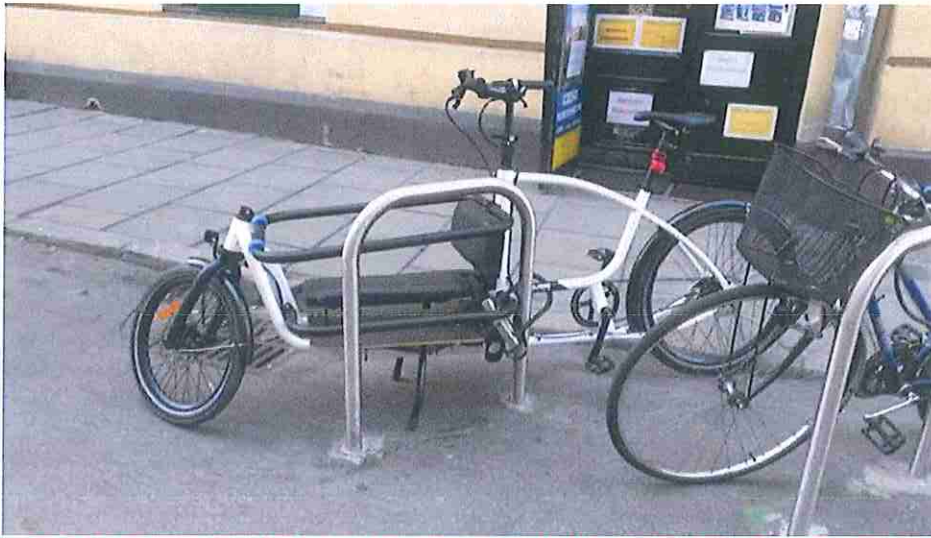
↑ Stojak umieszczony w jezdni w odpowiedniej odległości od chodnika pozwala zaparkować nawet nietypowy rower.
