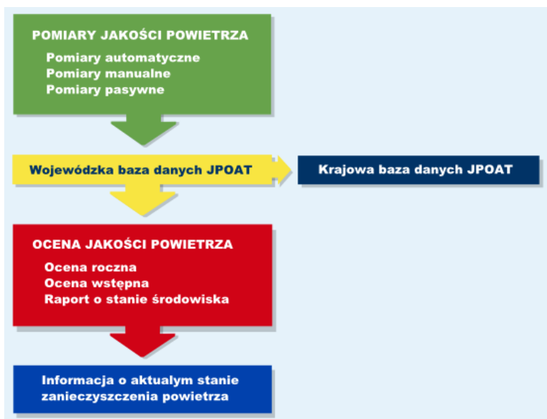
Rysunek 3.26 Schemat funkcjonowaniu monitoringu ochrony powietrza
