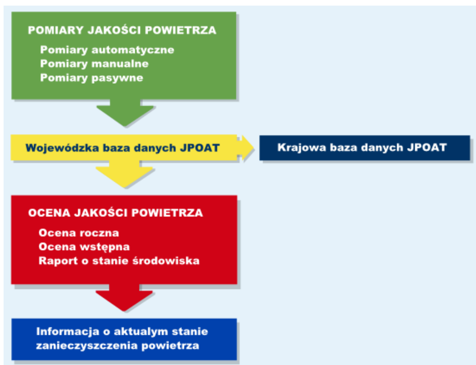
Rysunek 4.1 Schemat funkcjonowaniu monitoringu ochrony powietrza
