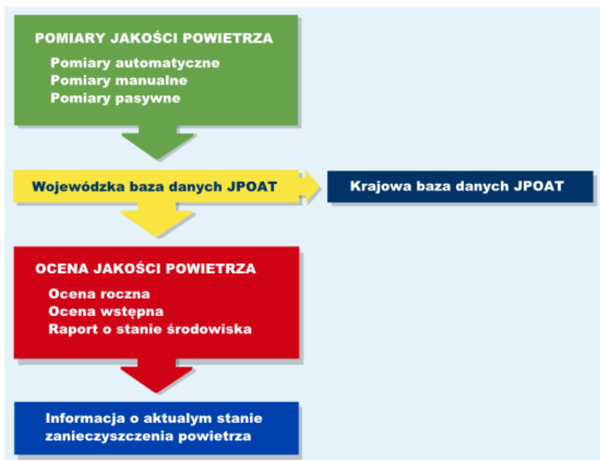
Rysunek 3.26 Schemat funkcjonowaniu monitoringu ochrony powietrza
